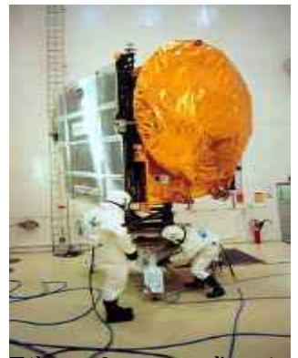
Télécom 2 en cours d'essais (configuration stockée)
