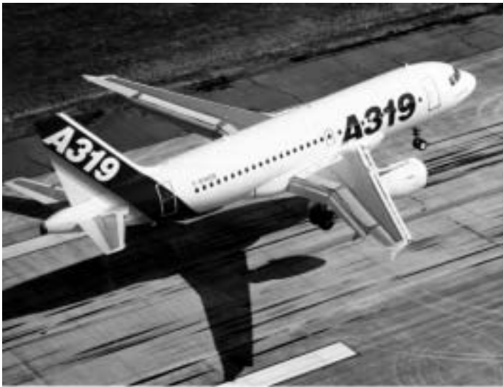
Airbus A319 à l'atterrissage avec les volets déployés
