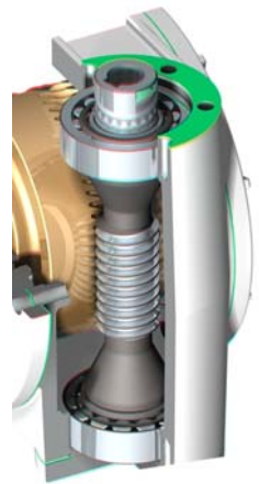
Figure 5 - Vue 3D d'un guidage classique en rotation
