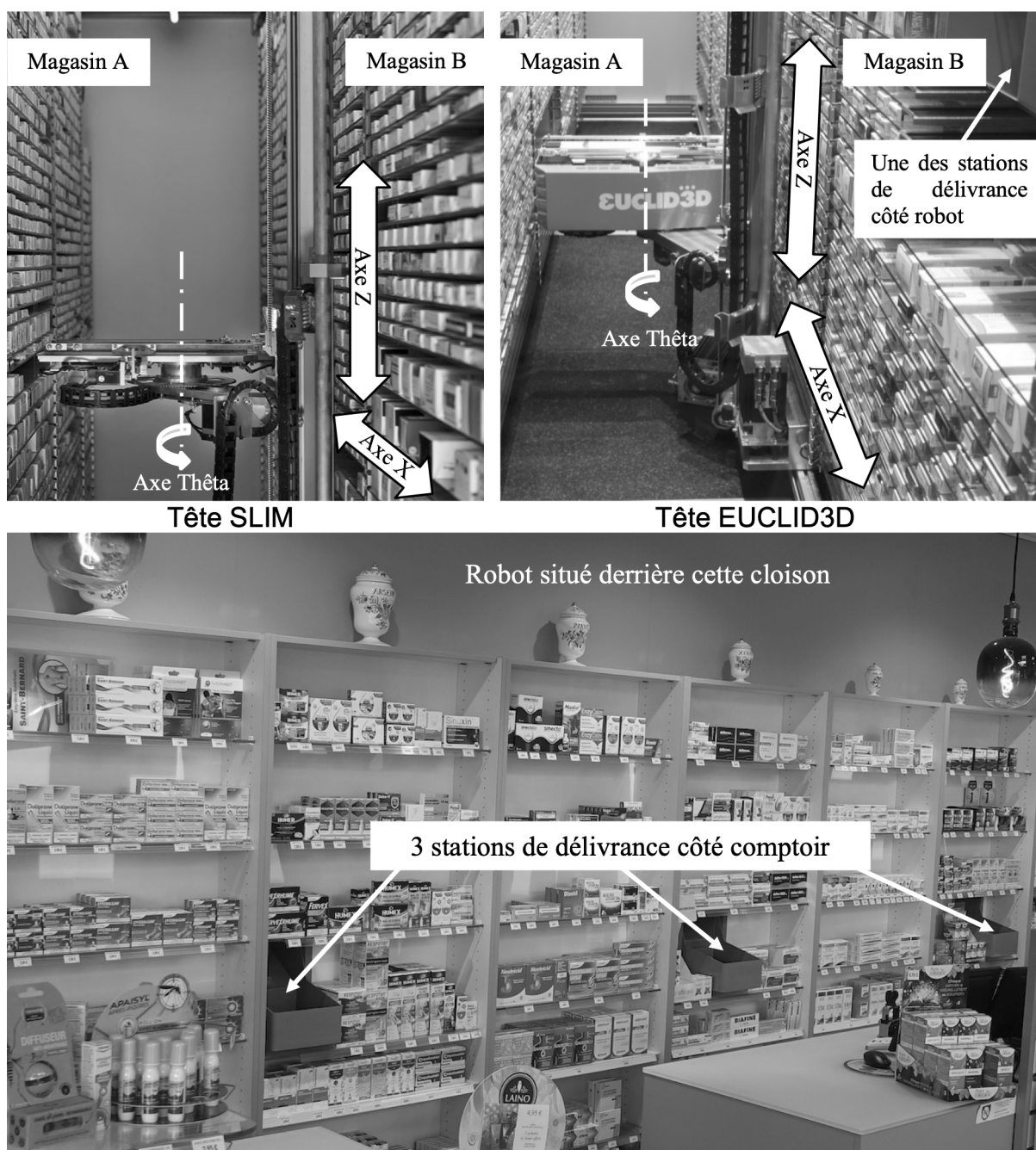
Figure 1 Robot SINTESI avec un seul bras et sa tête SLIM ou sa tête EUCLID3D
