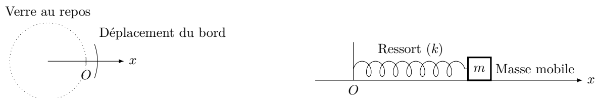
Figure 6 Modèle mécanique du déplacement
