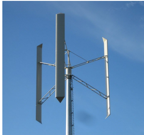
b) Éolienne Darrieus de type H
