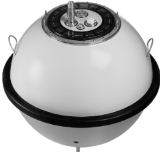
Figure 1 Photographies d'une bouée houlographe Waverider
