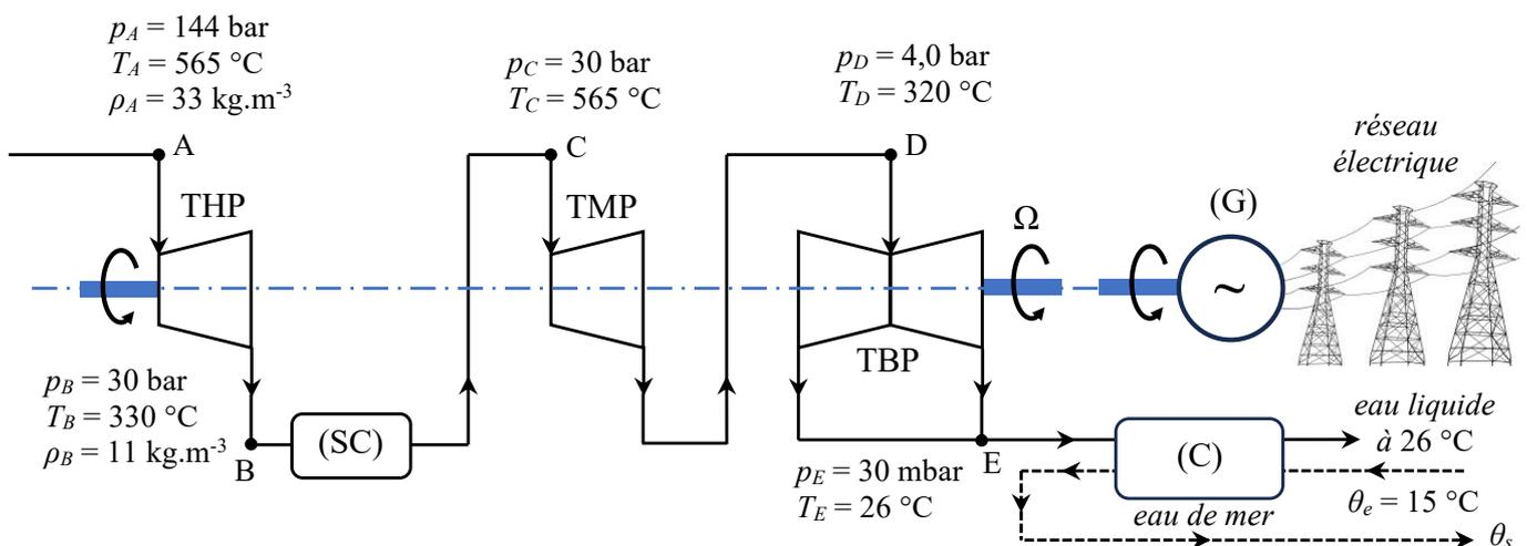
Figure 4 – Circuit de vapeur dans les turbines
