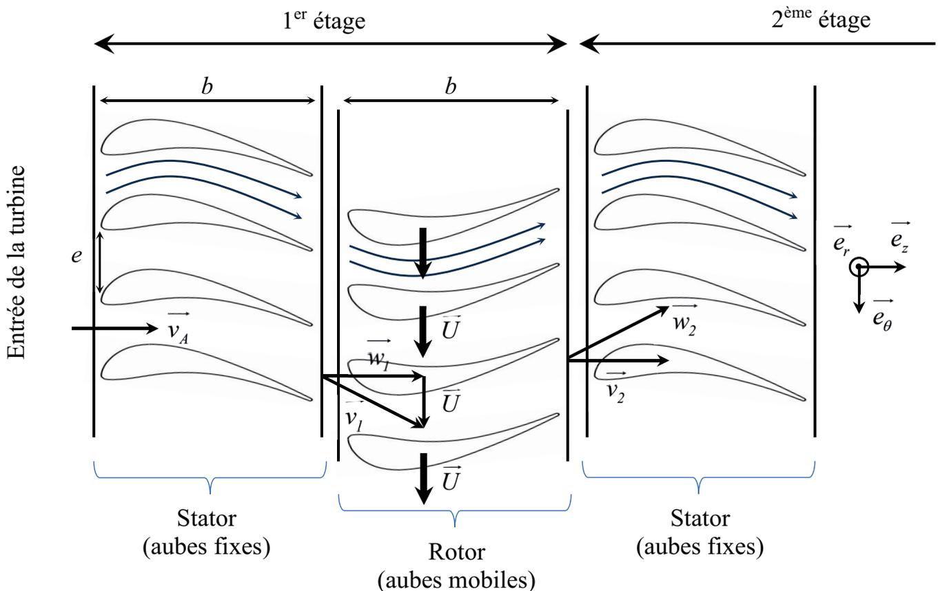
Figure 5 – Principe d'une turbine à réaction
