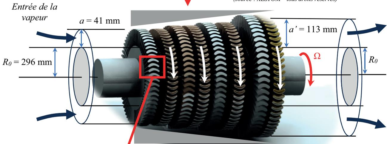
(b) Détail de la turbine HP. La vapeur circule entre les aubes des différents étages de détente
