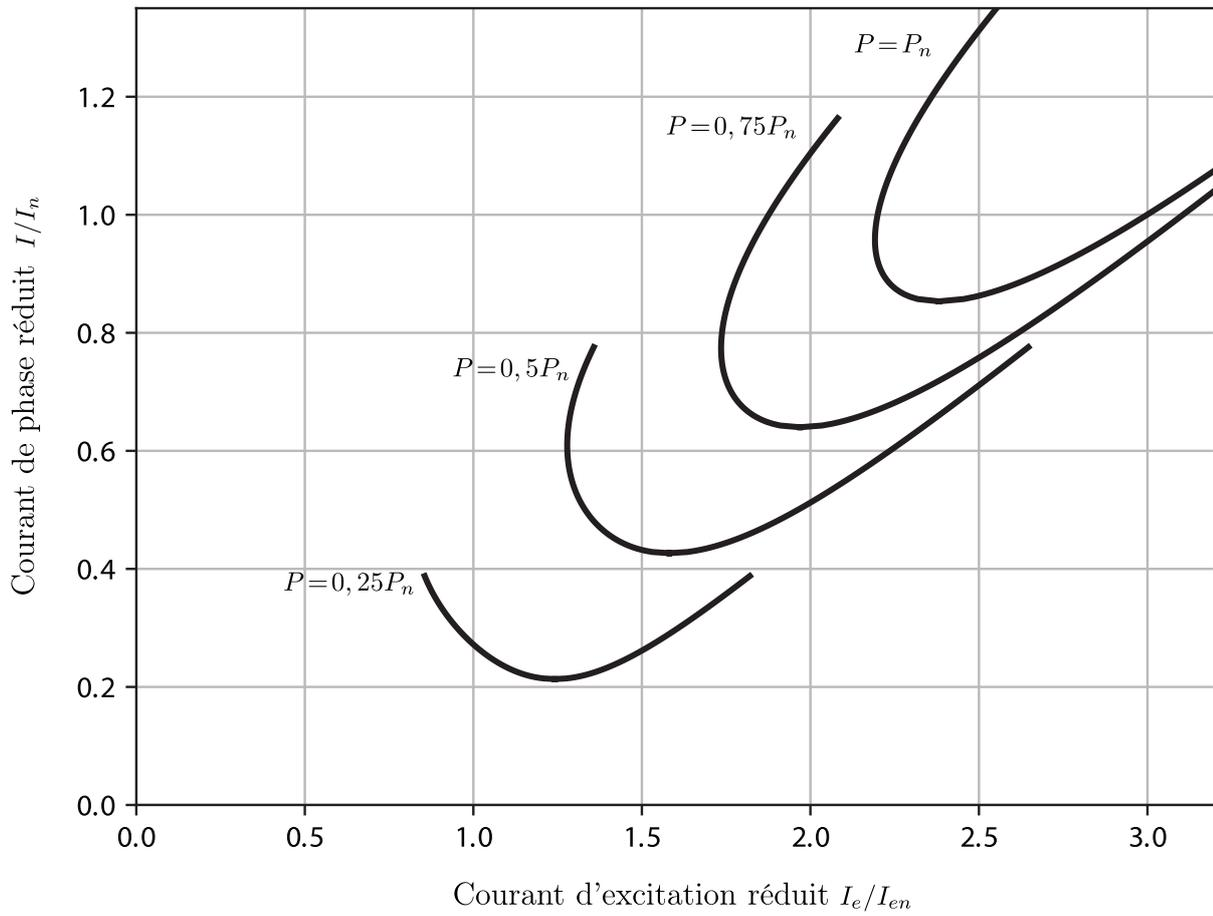
FIGURE 2 – Évolution du courant statorique en fonction du courant d'excitation à puissance constante
