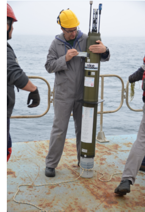
Figure 1 – Flotteur Argo juste avant son déploiement en mer par l'Ifremer. (K. Balem/RREX/Ifremer)
