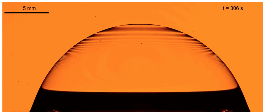
Figure 8 – Photographie de la bulle d'huile de silicone, éclairée par une lampe à vapeur de sodium à l'arrière. La photographie a été prise 306 secondes après la formation de la bulle [1].
