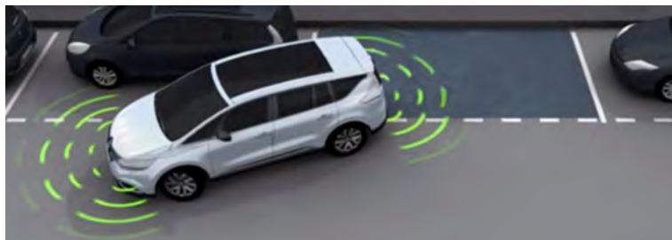
Figure 1 Détection par ultrasons (4 capteurs)
