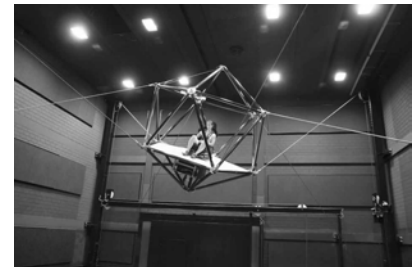
Simulateur de vol à six degrés de liberté et huit câbles répartis – Max Planck Institute for Biological Cybernetics (Allemagne)
