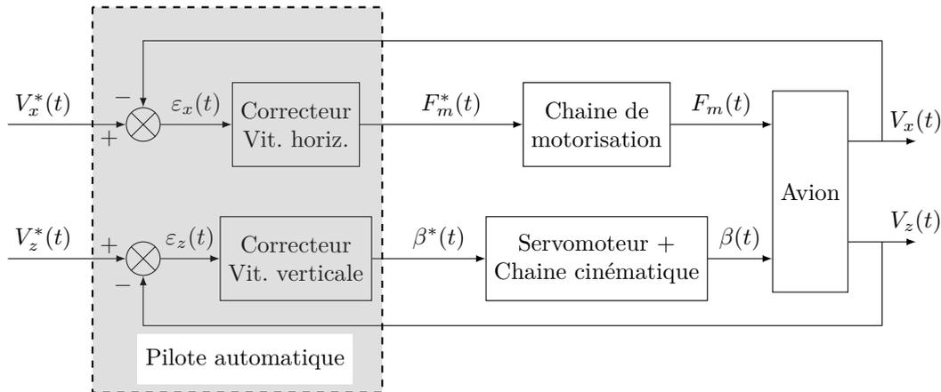
**Figure 2** – Structure restreinte du pilote automatique
