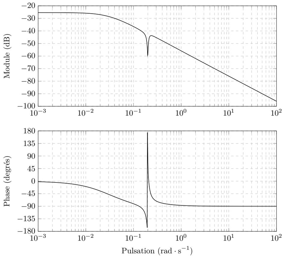
Figure 16 – Diagramme de Bode de  $H_1(p) - B(p)$
