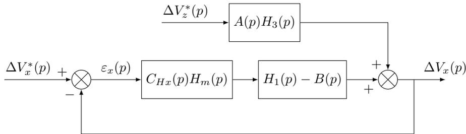
**Figure 11** – Boucle de vitesse horizontale perturbée
