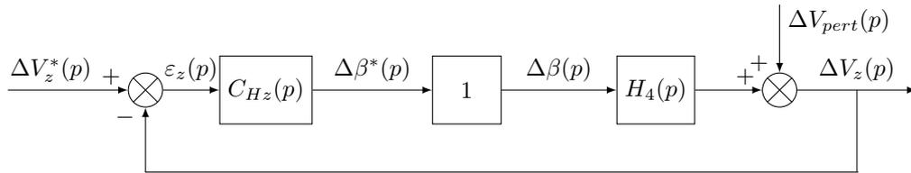
Figure 7 – Boucle de vitesse verticale linéarisée et découplée
