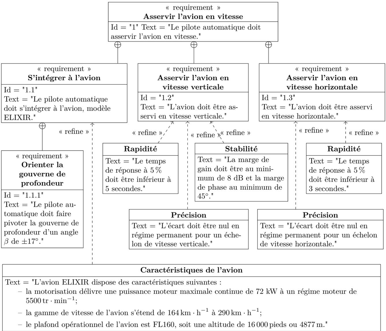
Figure 3 – Diagramme d'exigences pour l'asservissement de vitesse
