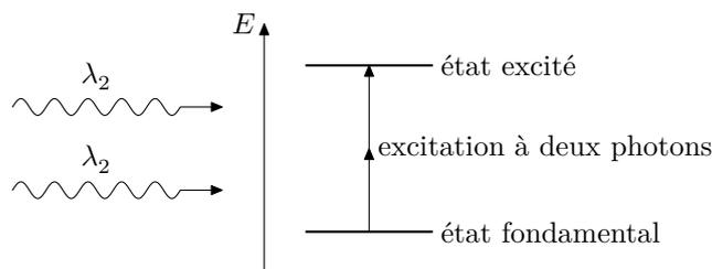
**Figure 4** Diagramme énergétique rendant compte du processus d'excitation d'une entité chimique par absorption simultanée de deux photons de longueur d'onde  $\lambda_2$  (en considérant seulement deux états possibles)
