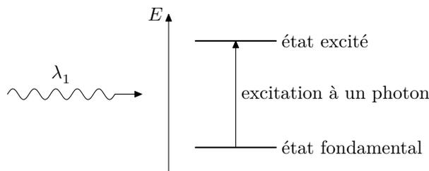
**Figure 2** Diagramme énergétique rendant compte du processus d'excitation d'une entité chimique par absorption d'un photon de longueur d'onde  $\lambda_1$  (en considérant seulement deux états possibles)
